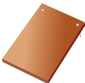
Fixation suivant le DTU 40.23
