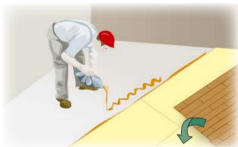
*Pose des lames de parquet en diagonale ou perpendiculaire à la longueur des sous-couches*
