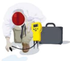
*L'humidité du support doit être inférieure à 3 % à environ 2 cm de profondeur*
