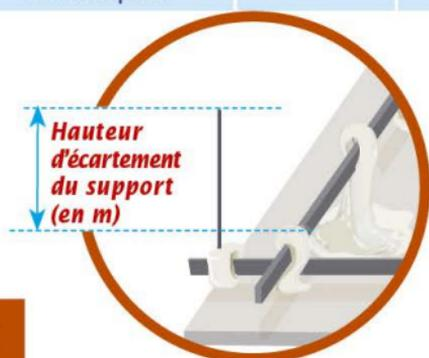
**Pour les hauteurs d'écartement supérieures à 4 m : les suspentes en tiges filetées doivent avoir un diamètre de 8 mm minimum.**
