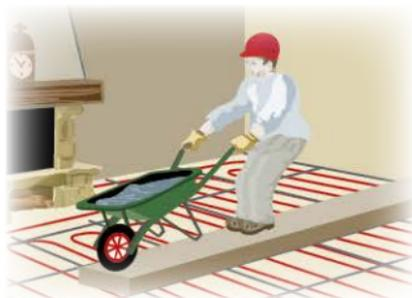
*Coulage sur une planche pour éviter que la brouette n'abîme les ouvrages (armatures métalliques et tubes)*
