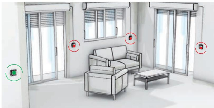
**Remarque:** Si les commandes de manœuvre manuelle de volets roulants sont situées à une hauteur de 1,40m, ce n'est pas conforme. La solution à effet équivalent est une commande centralisée à distance de la motorisation de tous les volets roulants.
